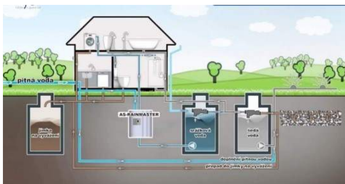
Obr. 76: Recyklácia šedej vody, zdroj: Pagroma.cz
